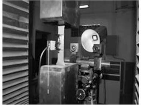
图 3 试件加上引伸计且布置好光学测量设备
